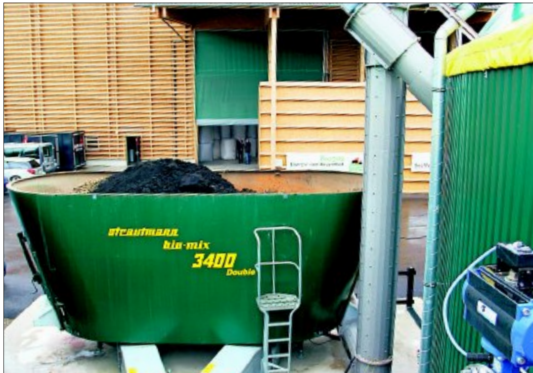
Der Energiepark Düdingen produziert seit diesem Frühjahr Strom und Wärme. Unser Bild zeigt den Biomasse-mischer und das Gebäude mit der Holzpelletpresse und dem Holzlager im Hintergrund. (Bild Hans Rüssli)
