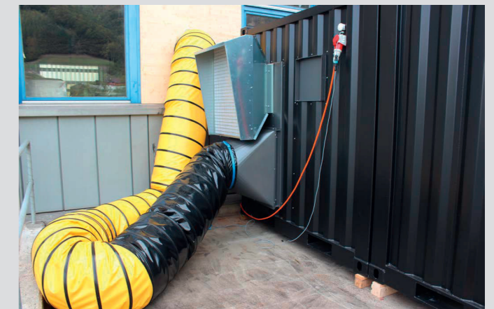
Wärme-Box von hinten: Luftansaug- und Ausblasstutzen
